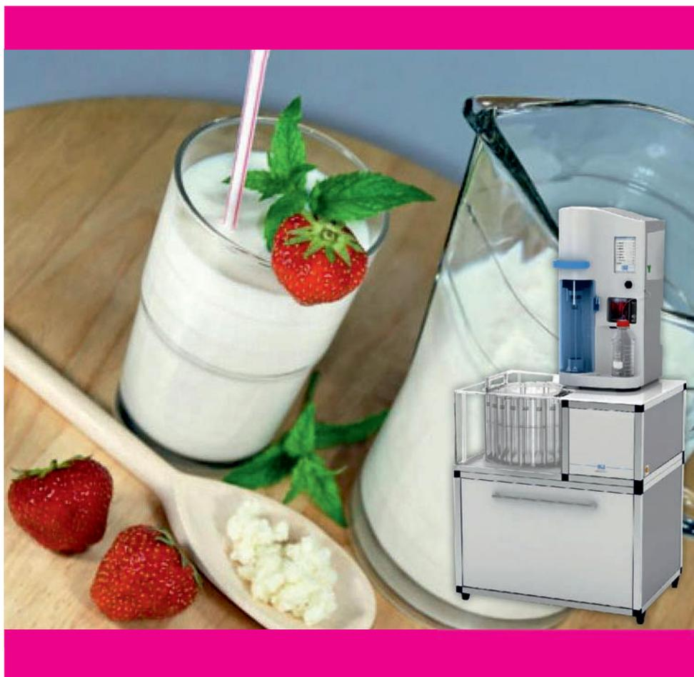
Analizado con Unidad de digestión automática Kjeldahl DKL 20 y unidad de destilación con automuestreador UDK 169 Kjeldahl VELP Scientifica
