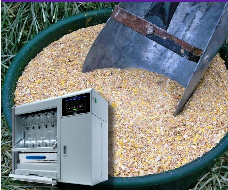
Analizado con autoextractor de fibra FIWE Advance y extractor en frío COEX VELP Scientifica
